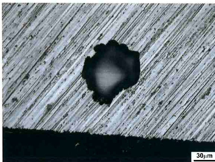
Figura 16 – Imagem representativa da interface metal-baquelite das amostras após ensaios de corrosão. Nota-se que a interface está íntegra e nota-se a presença de um pite. Aumento de 500x.
